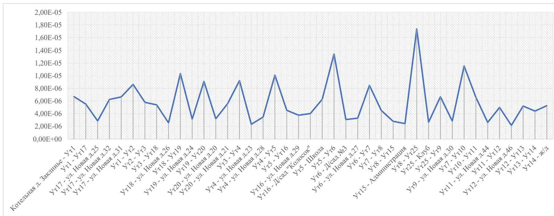
**Рисунок 17. Вероятность состояния тепловой сети ГВС от котельной д. Заклинье, соответствующая отказу  $f$  элемента,  $p_f$**
