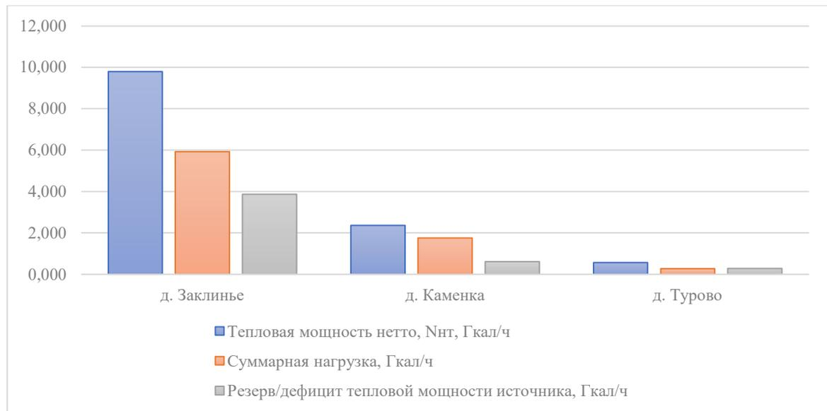
**Рисунок 21. Существующие балансы установленной, подключенной и резервной мощности централизованных источников тепловой энергии муниципального образования Заклинское сельское поселение**
