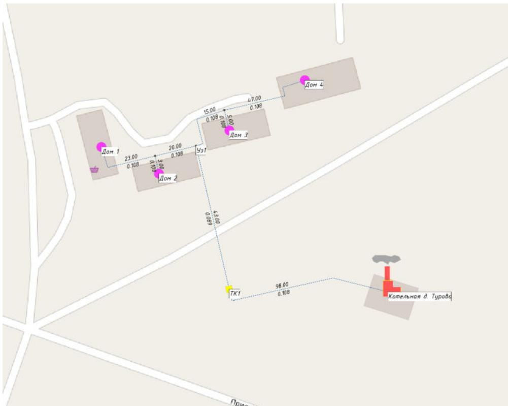
Рисунок 6. Схема тепловых сетей от котельной д. Турово
