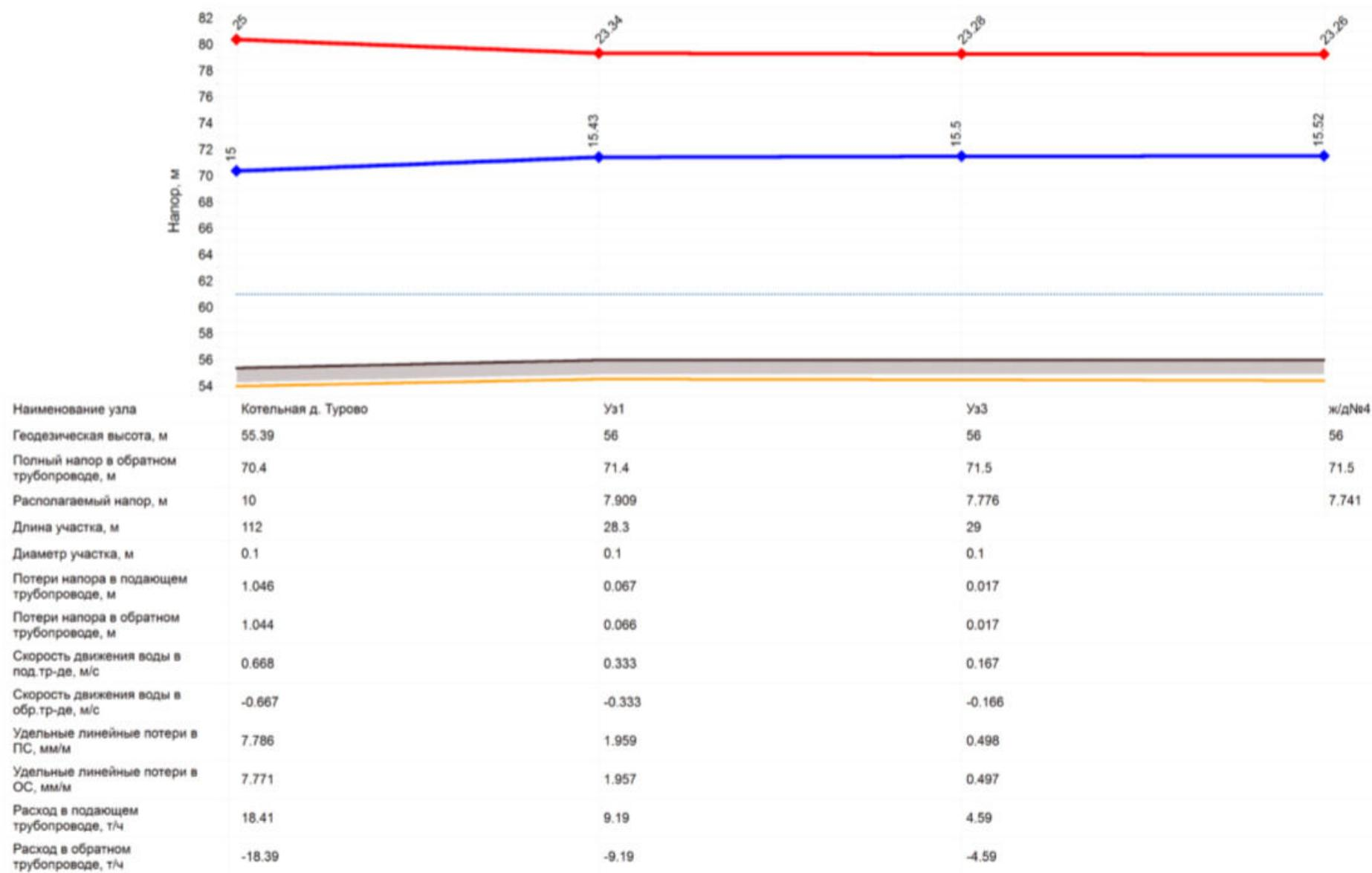
Рисунок 11. Пьезометрический график от котельной д. Турово до ж/д 4
