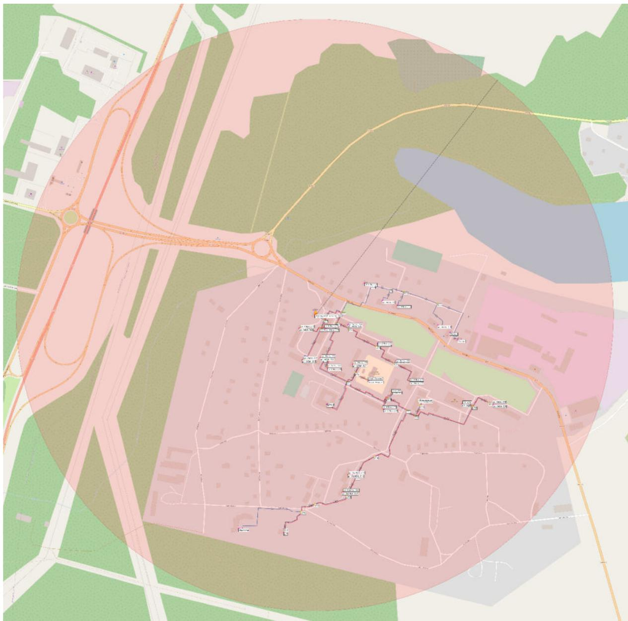
**Рисунок 6. Радиус эффективного теплоснабжения котельной д. Заклинье**
