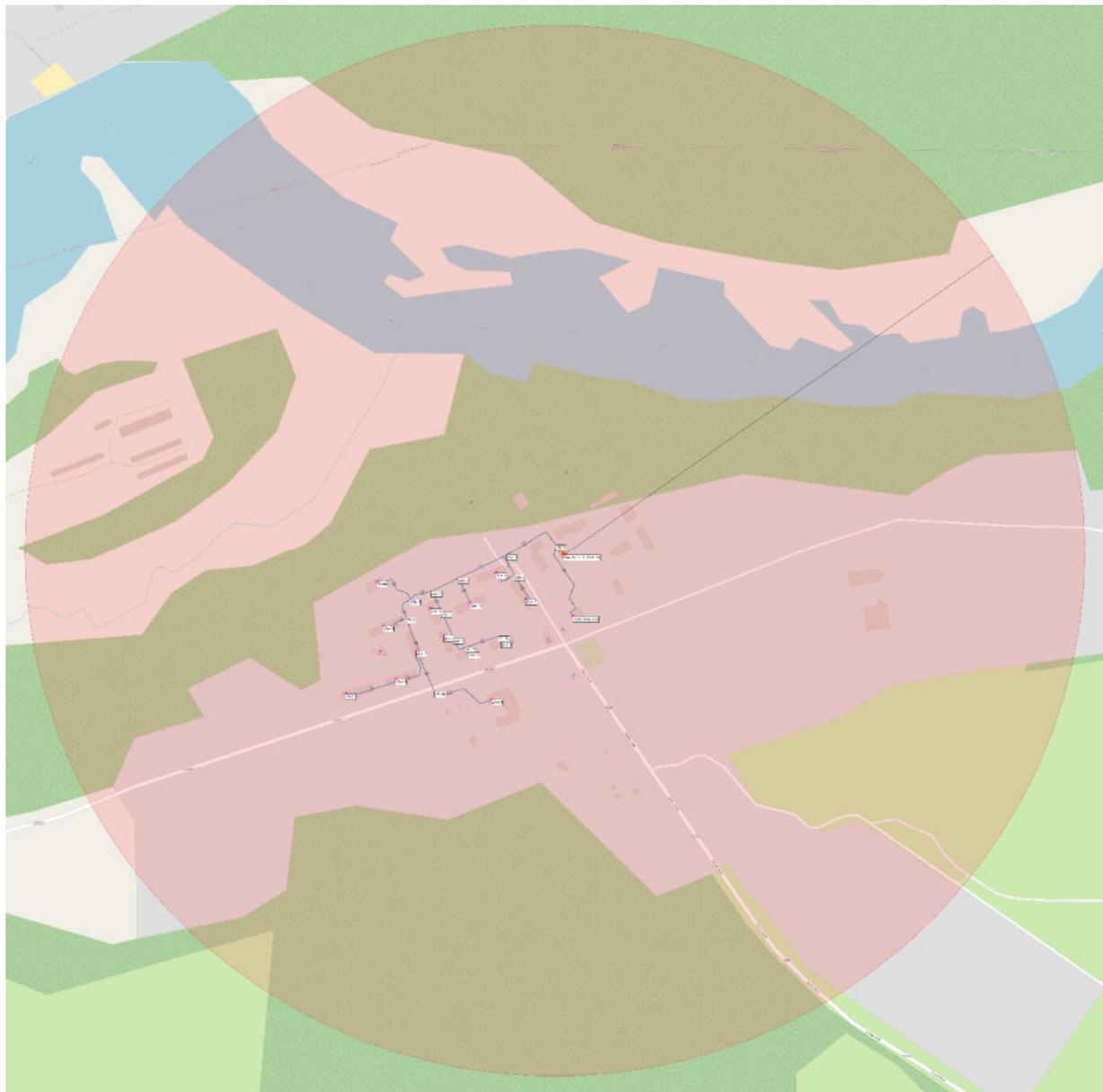
**Рисунок 7. Радиус эффективного теплоснабжения котельной д. Каменка**
